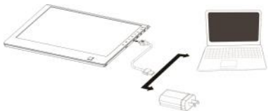
圖：Micro USB 充電線連接筆電或 5V 充電器
