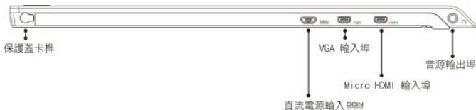
圖：On-Lap 2501 輸入輸出孔說明
