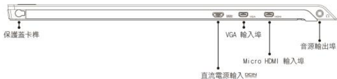
圖：On-Lap 2501 系列輸入輸出孔說明
